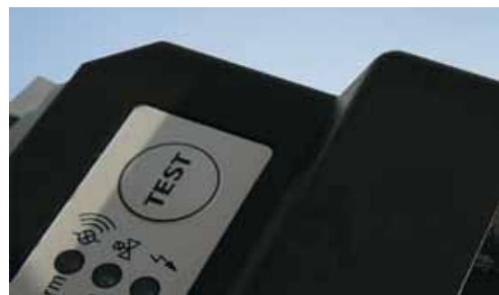
Control permanente, con pulsador manual de chequeo
